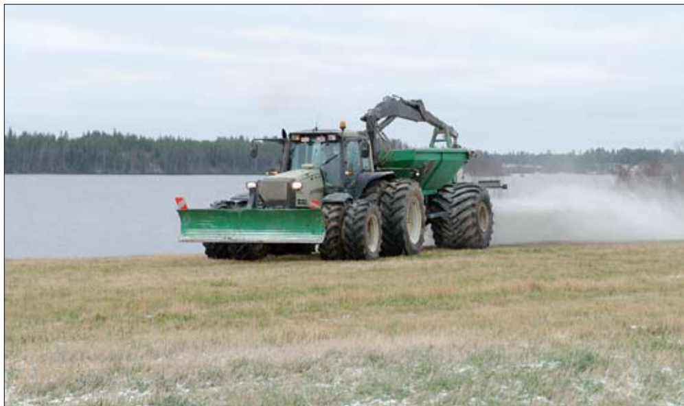
Talvi on parasta kalkin levityksen aikaa, sillä routainen maa kestää parhaiten painavat koneet. Kalkkia voi levittää muulloinkin, kunhan välttää märkien maiden tallaamista raskailla koneilla.
