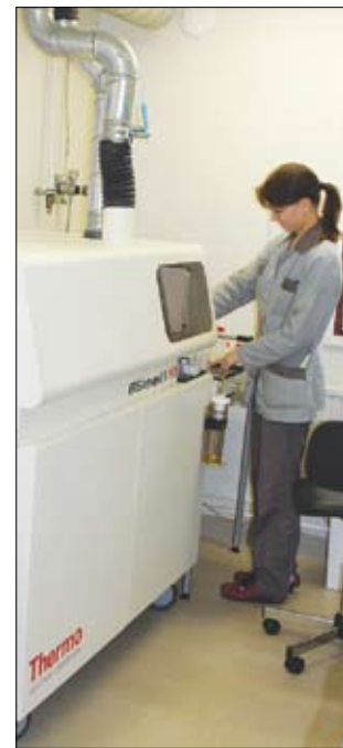
Laboratorioanalytiikko Sanna-Maija Nivala aloittamassa rikin määritystä ICP-emissiospektrometrillä.
