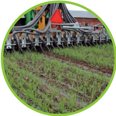
Lannanlevitystä multaavalla laitteella oraalle
