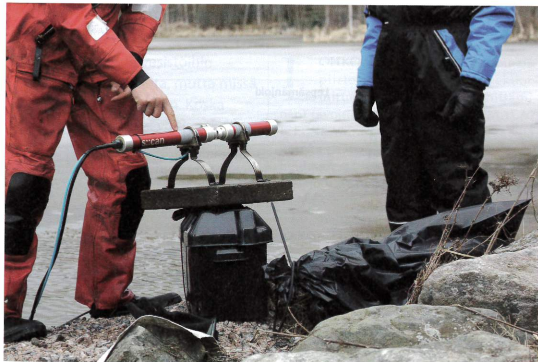
Kuva 2. Automaattisilla mittausantureilla saadaan entistä tarkempia arvioita ravinne- ja kiinto- ainekuormista. Tarkemmat arviot auttavat kuormitusmallien kehittämisessä.
