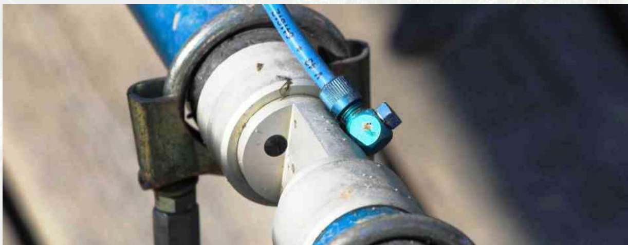
Vid sidan av traditionella vattenprover utnyttjas kontinuerlig mätning av vattenkvaliteten. Ur vattnet fastställs bland annat halten av kväve, fosfor och fasta partiklar. (Foto: P. Valkama)
