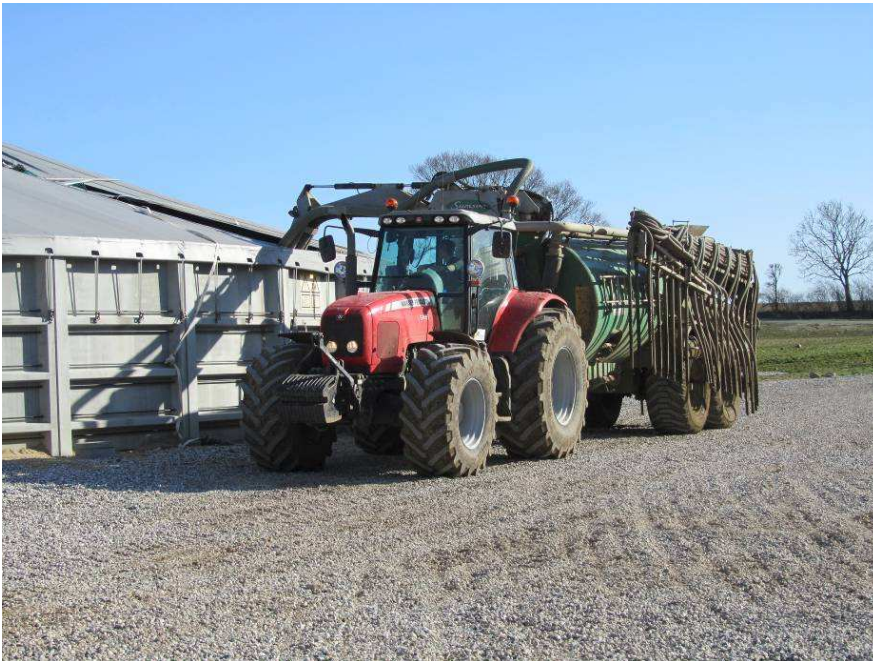
Kuva 4. Lannan hajalevitys on Tanskassa kielletty, joten liete levitetään sijoittamalla tai letkulevittimillä. Lannanlevitysvaunun omaa pumpppua käyttämällä vajaan 20 m 3 :n säiliön täyttämiseen kuluu vain pari minuuttia.
