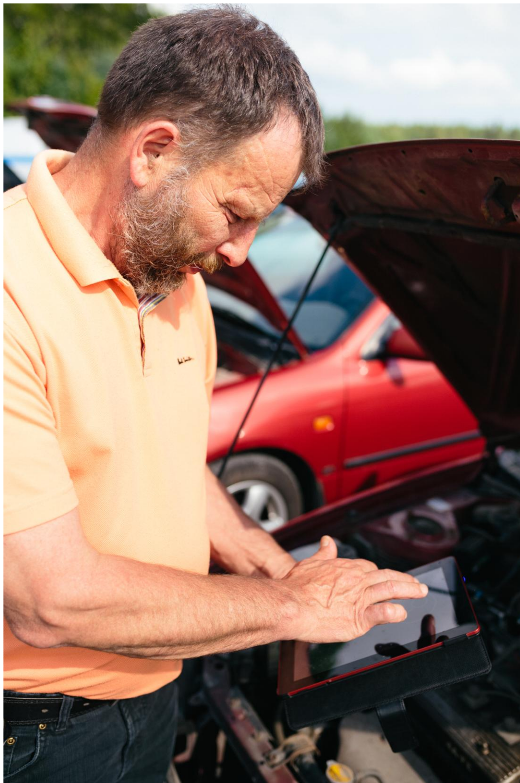
KUVA 4 Testaaja muodostaa tabletilla yhteyttä muutossarjaan.
