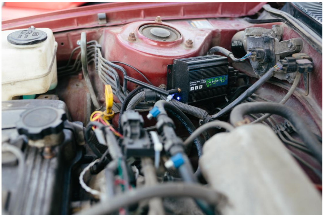
KUVA 3 Muutossarja asennettuna ajoneuvoon
